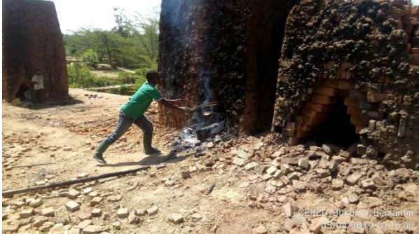
Image 2 : © Photo CEPED 2019, Four brique cuites par bois-énergie à Bukoma
